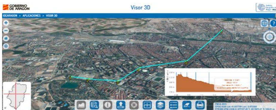
Ejemplo de geolocalización de una ruta y obtención de su perfil de altitud. Aplicación de la IDE de Aragón
