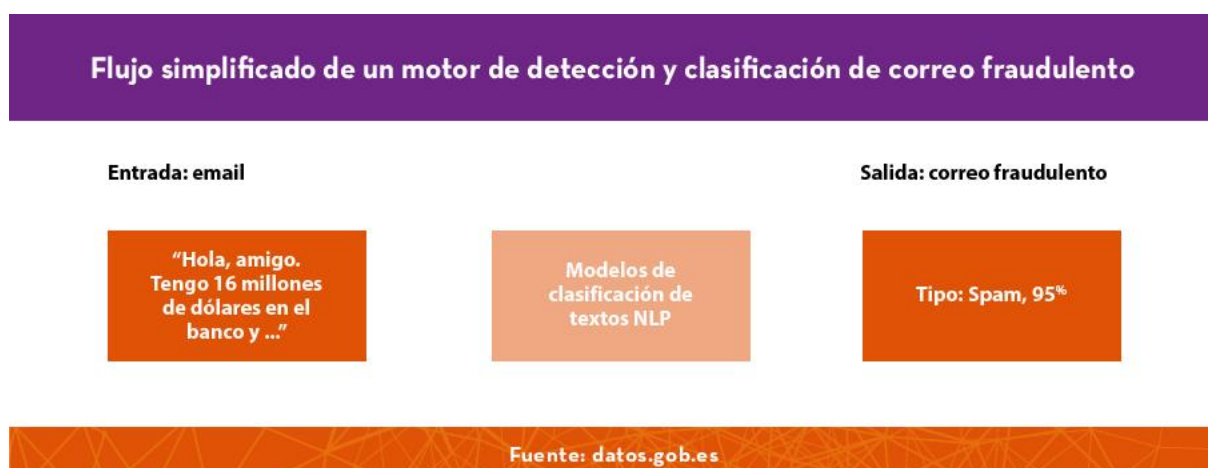
Figura 8. Flujo simplificado de un motor de detección y clasificación de correo fraudulento.
